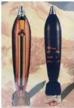
120 mm iranische Mörsergranate mit einem Hilfsraketenantrieb
