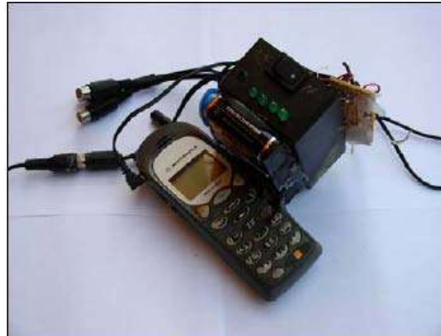
Ein drahtloses Detonationssystem, basierend auf einem Mobiltelefon, Für eine Kettendetonation von bis zu vier IEDs
