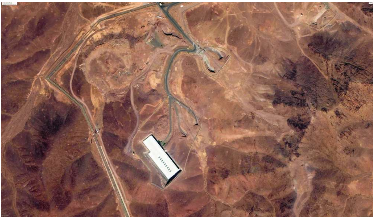
Abbildung 13: Im August 2018 sind die Tunneleingänge zur Anreicherungsanlage deutlich zu sehen. Im Berginneren steht für die Zentrifugenkaskade eine Halle von 250 x 13 Metern zur Verfügung. (Quelle: Google Earth)
